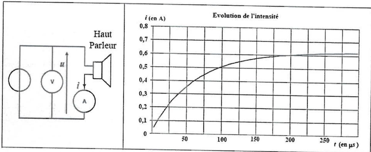
Le système d'acquisition en courant possède une résistance interne  $R_A = 2,0 \Omega$ . Le voltmètre possède une résistance interne  $R_V = 1,0 M\Omega$ .
