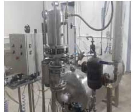
Intensification de la Vaporisation par Détente vers le Vide, réacteur Pilot.
